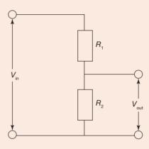
If  $V_{\rm in}=12$  V,  $R_1=5.0$  k $\Omega$  and  $R_2=3.0$  k $\Omega$ , what is  $V_{\rm out}$ ?
