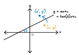
$$\begin{bmatrix} x' \\ y' \end{bmatrix} = \begin{bmatrix} \cos(2\theta) & \sin(2\theta) \\ \sin(2\theta) & -\cos(2\theta) \end{bmatrix} \begin{bmatrix} x \\ y \end{bmatrix} - \begin{bmatrix} 0 \\ c \end{bmatrix} + \begin{bmatrix} 0 \\ c \end{bmatrix}$$
