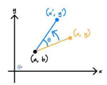
$$\begin{bmatrix} x' \\ y' \end{bmatrix} = \begin{bmatrix} \cos(\theta) & -\sin(\theta) \\ \sin(\theta) & \cos(\theta) \end{bmatrix} \begin{bmatrix} x \\ y \end{bmatrix} - \begin{bmatrix} a \\ b \end{bmatrix} + \begin{bmatrix} a \\ b \end{bmatrix}$$
